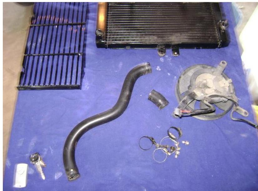
On récupère la sonde de température et on la replace sur le nouveau radiateur (on n'oubliera pas de la rebrancher). De même on récupère les silent blocs et on les glisse (non sans mal) sur le nouveau radiateur.
