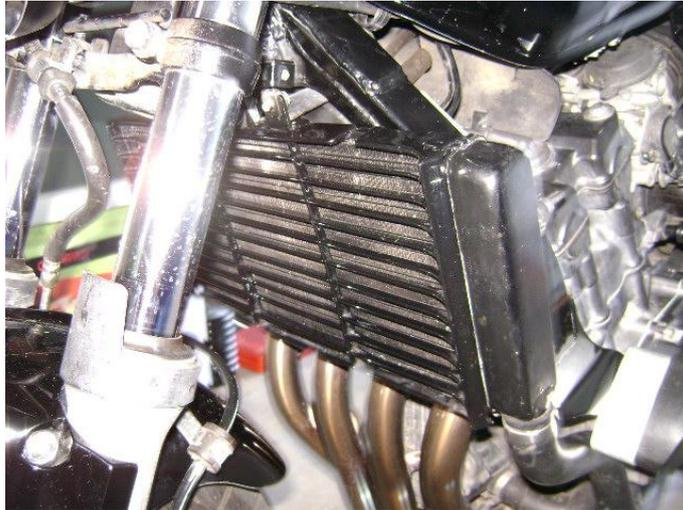
Premièrement, il va falloir vider le radiateur de son liquide de refroidissement. Pour ce faire, on va dévisser le bouchon du radiateur. Attention il y a une petite vis à ôter.
