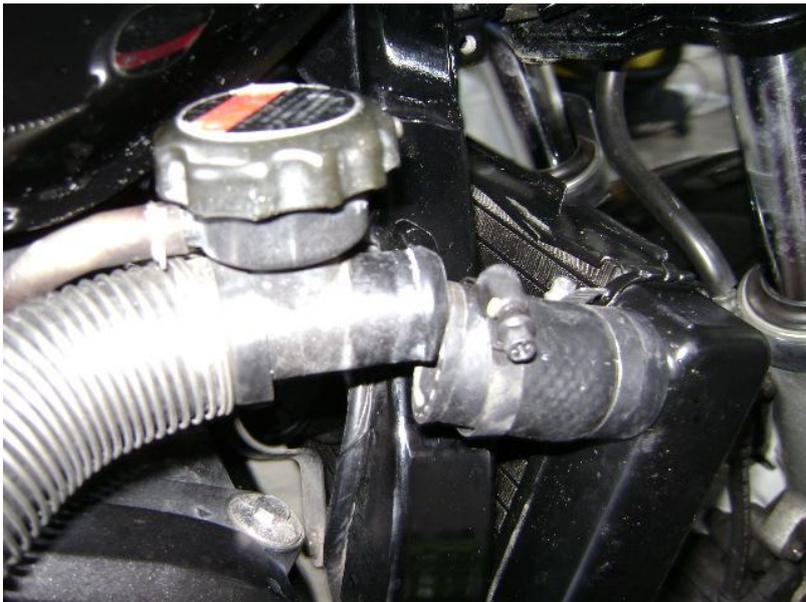
Ensuite on va dévisser les 2 écrous de fixation sur les cotés et celui situé sur le haut. On veillera tout de même à maintenir le radiateur en place.
