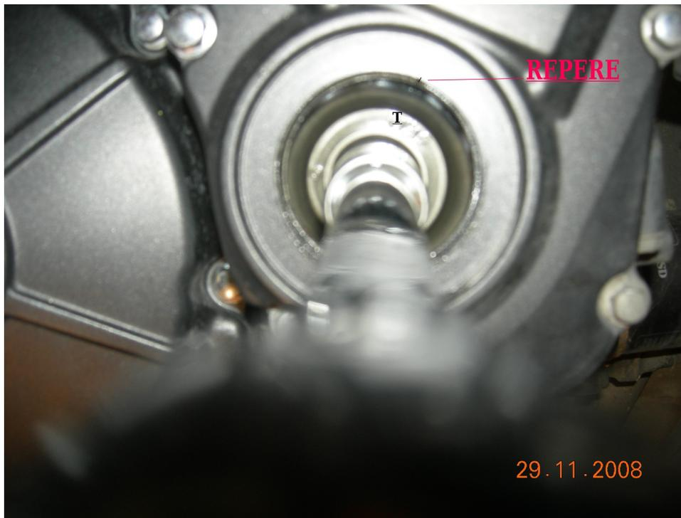
Ne pas hésiter à faire tourner le vilebrequin dans le sens d'une aiguille d'une montre et à s'assurer que le calage de la distribution soit bon. Si celui-ci n'est pas bon, déposer l'ensemble et recommencer.
